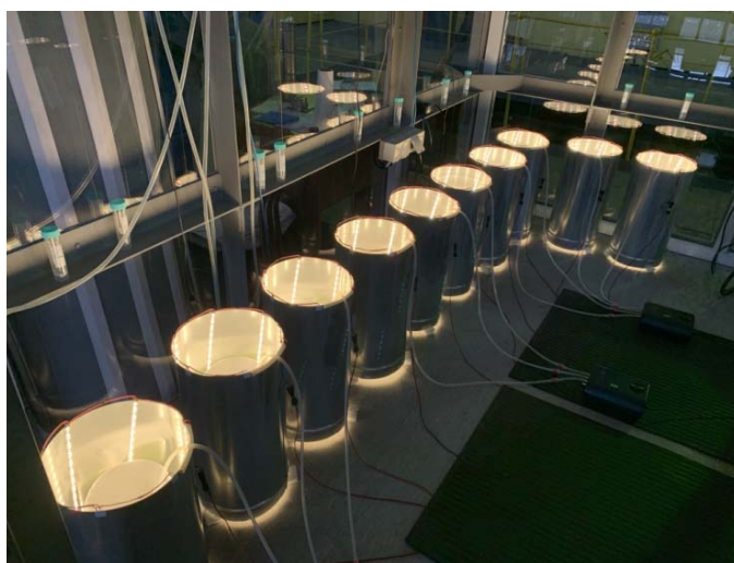
Рис. 2. Камера для проведения экспериментов с газовоздушной атмосферой заданного состава и большой фотобиореактор в ней (а). Внешний вид малых фотобиореакторов в экспериментальной камере (б).
